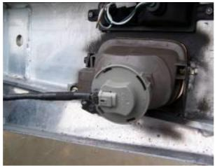
LOCATE LIGHT WITH ORIGINAL 6mm SCREW AFTER REMOVING PLASTIC CLIP AND PLASTIC SLEEVE IN LIGHT HOUSING
