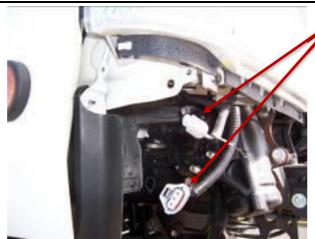
DISCONNECT HARNESS PLUGS FROM INDICATOR LAP AND PARKER LAMP AS SHOWN
