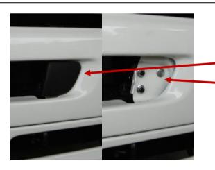
REMOVE THE BUMPER BAR BY REMOVING BLACK PLASTIC COVERS TO ACCESS THE FASTENERS RETAINING THE BUMPER
